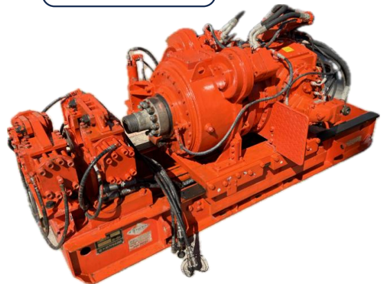
使用機械 (ソニックドリル)
