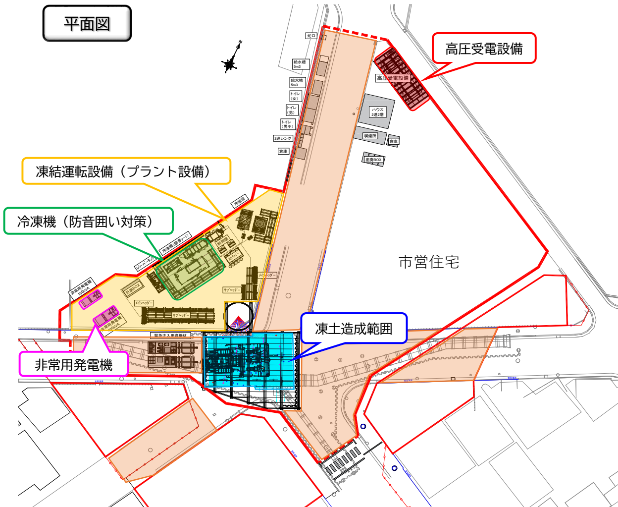
騒音対策(冷凍機への防音シート囲い)
